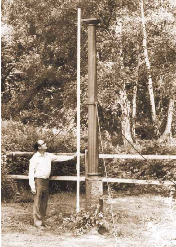
Afb. 6. Inklinking kan meer dan 2 cm/j bedragen. Om de mate van inklinking te registreren, sloeg de eigenaar, voorafgaand aan de drainage van het Holme Fen, een groot moerasgebied ca. 50 km ten noordwesten van Cambridge, een eiken paal tot op de harde bodem in de grond. Hij zaagde de paal gelijk met de grond af. Nu, ruim 160 jaar later, staat de – later door dit gietijzeren exemplaar vervangen – ‘Holme Post’ ruim 4 m boven het maaiveld.
